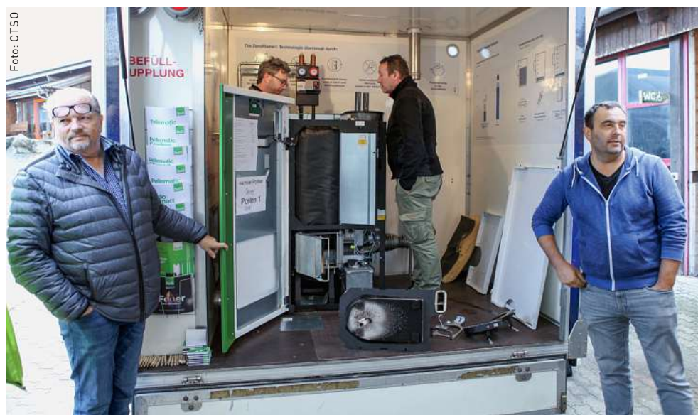
Oekofen presenta un sistema di riscaldamento a pellet con motore Stirling.
